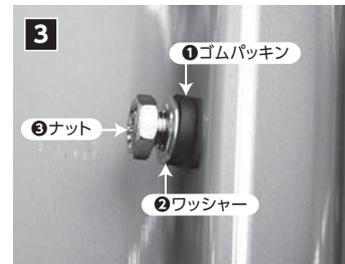
ホイール裏面(タイヤ装着側)に出てきたバルブ本体に、①もう一つのゴムパッキン、②ワッシャー、③ナットの順に組み込みます。
