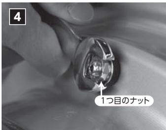
ナットを手である程度、締め込んだ後、12mmのスパナで増し締めをします。
