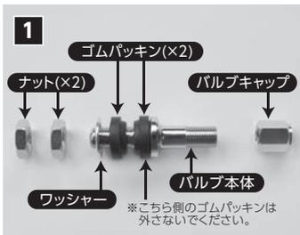
バルブを図のように分解します。この時、右側のゴムパッキンだけは外さずに、そのまま残してください。
