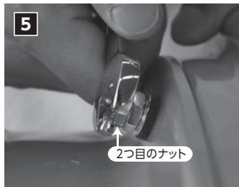
その後、もう一つのナットを、先に締めたナットの上から、更に締め込みます。
