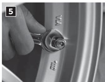
先に入れたワッシャーの上から、ナットを手である程度、締め込んだ後、12mmのスパナで増し締めをします。
