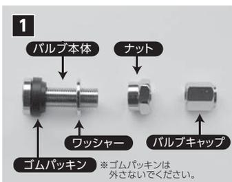
バルブを図のように分解します。この時、ワッシャーも外してください。ゴムパッキンだけは外さずに、そのまま残してください。
