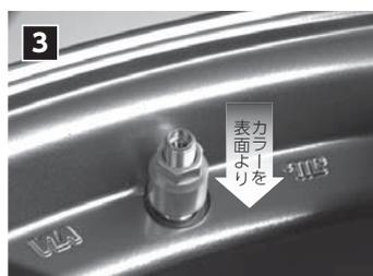
ホイール表面(デザイン側)に出てきたバルブ本体のネジ部へカラーを手で締め込みます。
