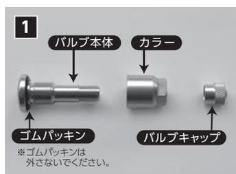
バルブを図のように分解します。この時、ゴムパッキン(Oリング)だけは外さずに、そのまま残してください。
