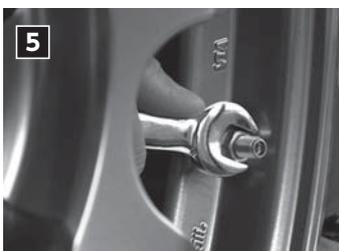
カラーを手である程度、締め込んだ後、11mmのスパナで増し締めをします。
