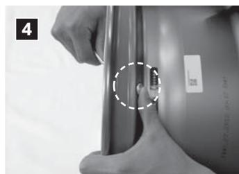
カラーを手で締め込む際、バルブ本体の裏面を親指でホイールに押さえつけながら多少、力を入れて締めます。
