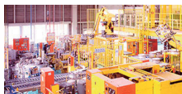
タービル式鑄造システムMAP The development of MAP with tilt pour casting method.
